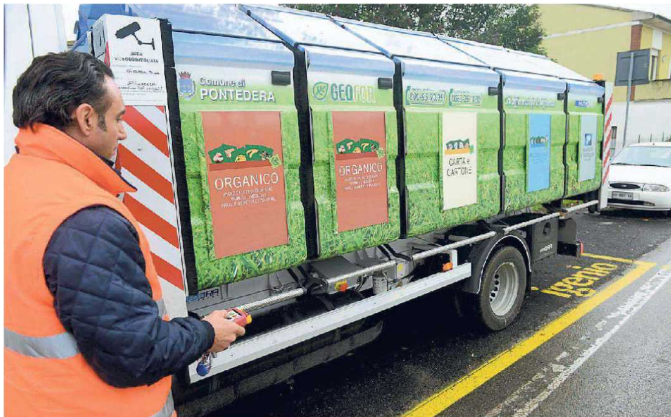
Igenio, punto mobile di raccolta rifiuti posizionato su spazi dedicati
